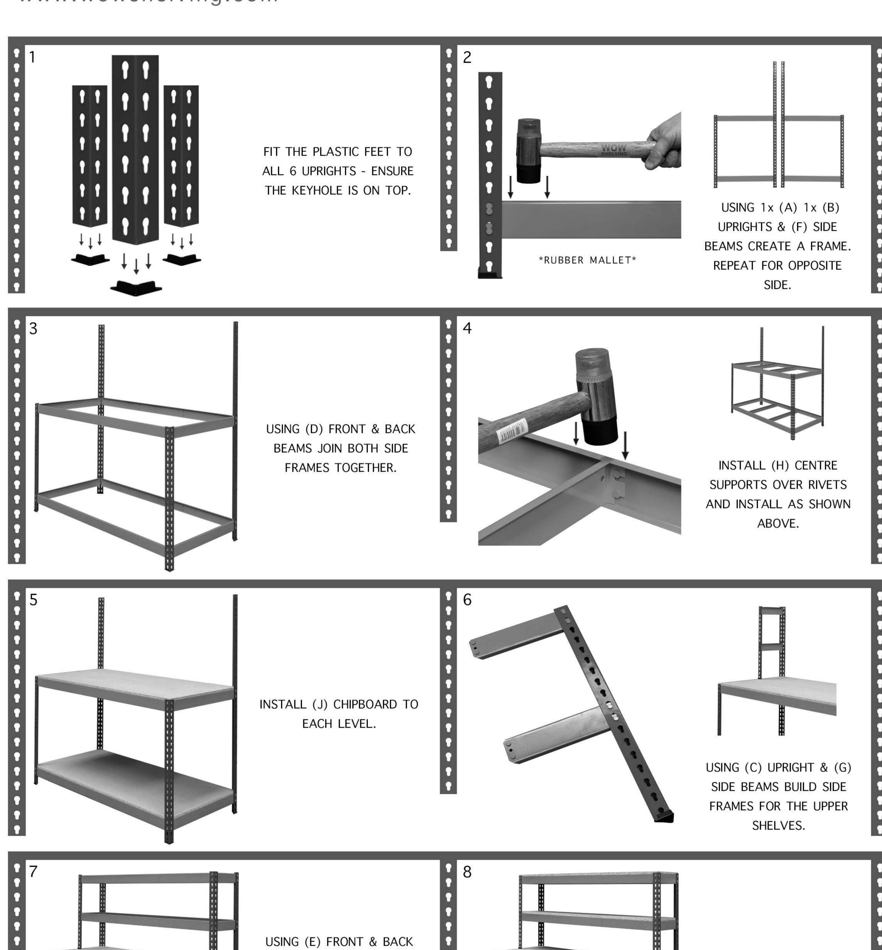
BEAMS JOIN SIDE FRAMES
